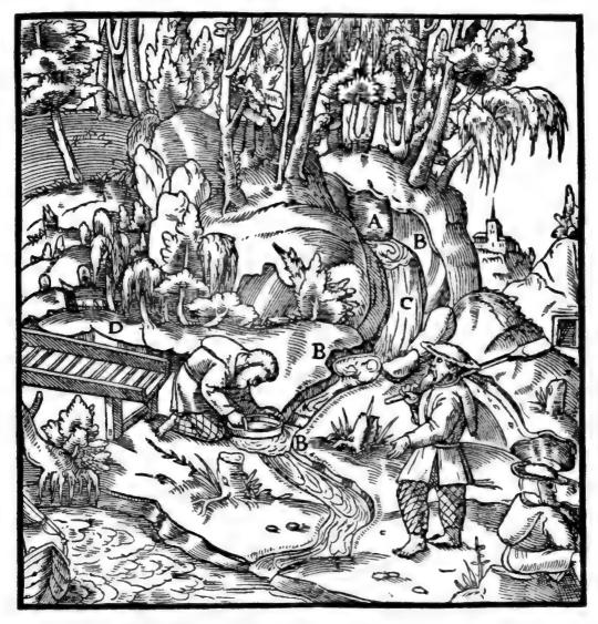
A-GULLY. B-DITCH. C-TORRENT. D-SLUICE BOX EMPLOYED BY THE LUSITANIANS.
